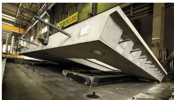
工場で製造されたプレキャスト コンクリート
