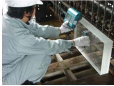
B法：実際の配筋を用いて補正値を求める
