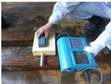
標準試験片による測定精度の点検
