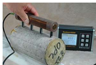
電気抵抗計測器の例
