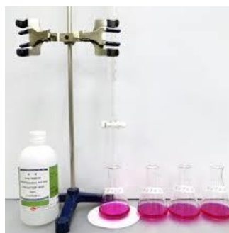
中和滴定法による アルカリ濃度減少 量の定量
