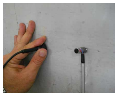
衝撃弾性波試験状況
