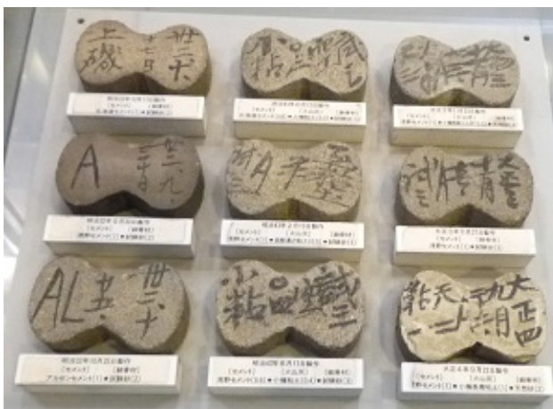
現在も残っている供試体 (モルタル・ブリケット) 60,000個制作され4,300個が現存
