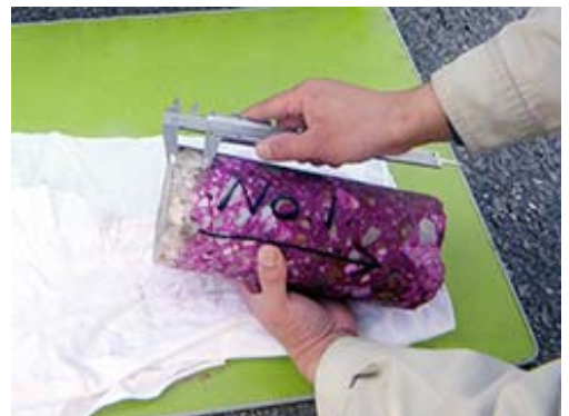
中性化深さの測定
